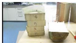
2C (Ø 17 cm) diverse grotere plekken die nog steeds water transporterend zijn over de hele lengte
