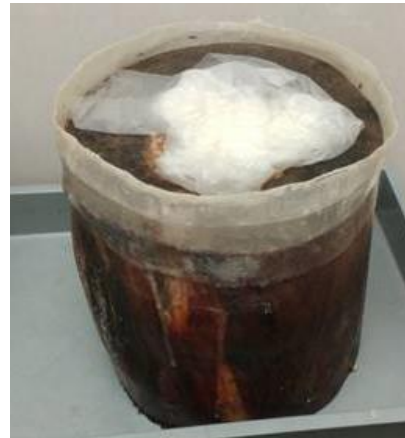
Afgekoppelde verblauwde stam in een warme donkere klimaatkamer met een suikeroplossing op het kopse hout
