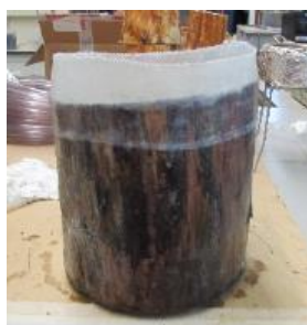
Aanbrengen van de kraag en epoxy
