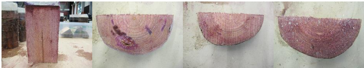
Paal 4B: buiten enige waterindringing in de eerste 3 cm is er geen watertransport door de paal
