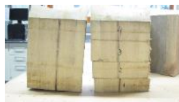
1C (Ø 20 cm): waterstroming door het merg, verder goede afsluiting, enkele kleine plekkjes aan de buiten kant maar deze zijn oppervlakkig (< 10 cm diep)
