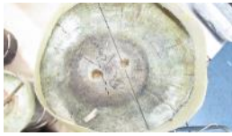
1D (Ø 29 cm): in de buitenrand waterstroming tot ongeveer 20 cm diep op enkele plaatsen
