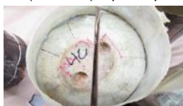
4C (Ø 25 cm): via een paar kleine plekkjes watertransport, maar niet door de hele stam
