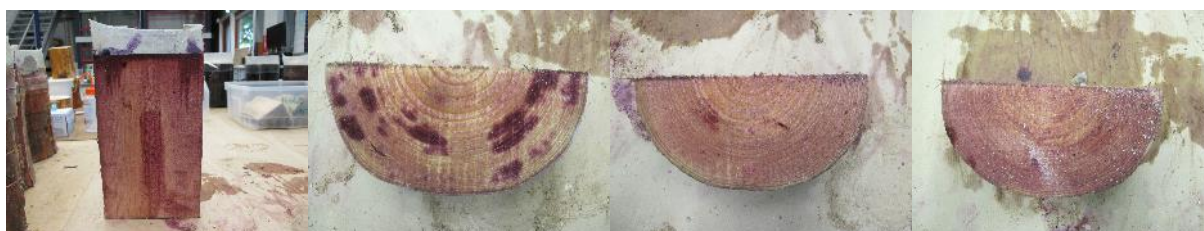
Paal 3A: alleen in de bovenste 8 cm enige waterindringing, verder geen watertransport door de paal
