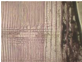
4C1a: blauw en slijm in stralen en tracheiden
