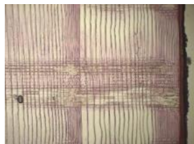
1Ca1: slijmachtige structuur in stralen in de buitenkant van de paal
