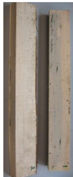
Na 5 dagen, verdere uitbreiding van de oppervlakkige verblauwing
