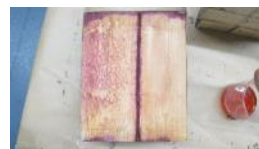
1C (Ø 20 cm): waterstroming door het merg, verder goede afsluiting, enkele kleine plekkjes aan de buiten kant maar deze zijn oppervlakkig (< 10 cm diep)
