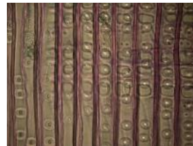
4C3a: veel dikke hyphen in tracheiden
