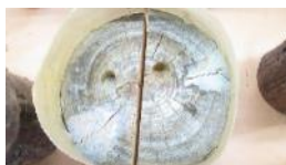
1C (Ø 20 cm): waterstroming door het merg, verder goede afsluiting, enkele kleine plekkjes aan de buiten kant maar deze zijn oppervlakkig (< 10 cm diep)
