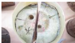
3C (Ø 30 cm): op een paar kleine plekkjes watertransport, echter niet door de hele stam
