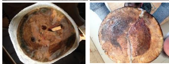
1C, met twee radiale scheuren over de gehele lengte doorlopend. Bovenste foto's genomen vóór het experiment, de onderste foto's bij het schoonmaken op 4 oktober 2016
