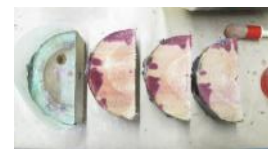
1C (Ø 20 cm): waterstroming door het merg, verder goede afsluiting, enkele kleine plekkjes aan de buiten kant maar deze zijn oppervlakkig (< 10 cm diep)
