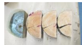
1C (Ø 20 cm): waterstroming door het merg, verder goede afsluiting, enkele kleine plekkjes aan de buiten kant maar deze zijn oppervlakkig (< 10 cm diep)
