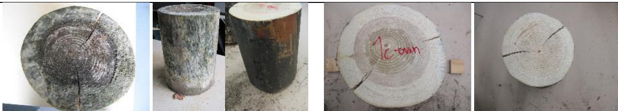
1C, met twee radiale scheuren over de gehele lengte doorlopend. Bovenste foto's genomen vóór het experiment, de onderste foto's bij het schoonmaken op 4 oktober 2016
