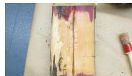
3C (Ø 30 cm): op een paar kleine plekkjes watertransport, echter niet door de hele stam
