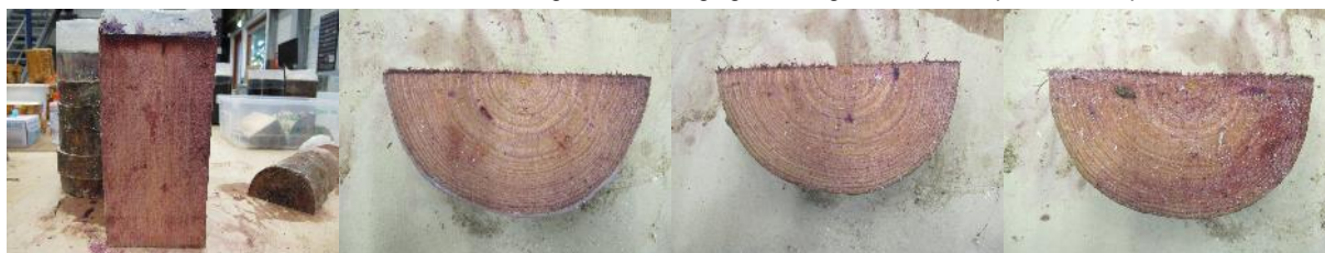
Paal 4A: geen watertransport door de paal
