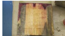
1D (Ø 29 cm): in de buitenrand waterstroming tot ongeveer 20 cm diep op enkele plaatsen
