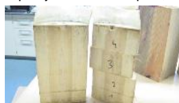
4C (Ø 25 cm): via een paar kleine plekkjes watertransport, maar niet door de hele stam
