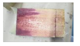
4C (Ø 25 cm): via een paar kleine plekkjes watertransport, maar niet door de hele stam
