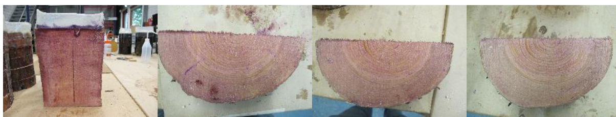
Paal 2B: buiten enige waterindringing in de eerste cm is er geen watertransport door de paal
