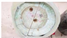
2C (Ø 17 cm) diverse grotere plekken die nog steeds water transporterend zijn over de hele lengte
