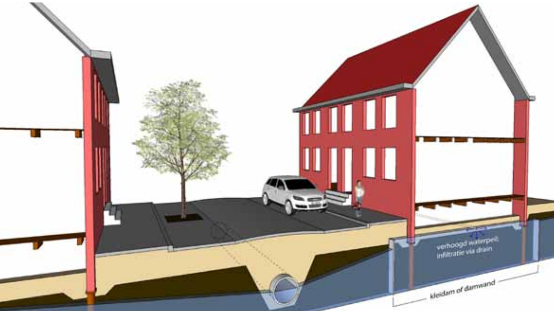
Dwarsdoorsnede Nederlandse straat met lekkende riolering waarbij er rond de fundering een verhoogd waterpeil wordt gehandhaafd, door middel van damwanden en een infiltratieleiding
