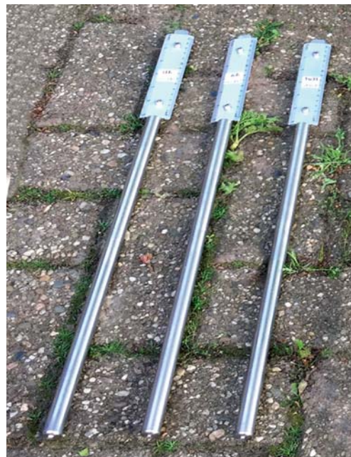
Figuur 7b – Opzetdelen zakbaken met liniaaltjes (boven het maaiveld).
