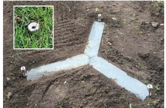
Figuur 8 – Plateau voor de Leica (drie aan elkaar gelaste L-profielen).
