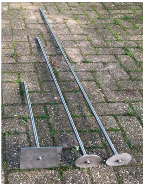
Figuur 7a – Zakbaakdelen die onder het maaiveld zitten voor 0,6 - 1,2 - 1,8m diepte.
